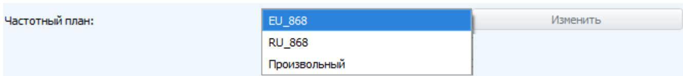
Вега Smart-SS0101 поддерживает следующие частотные планы:
